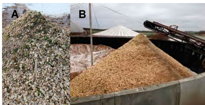
Billede 1a og 1b. Knuste roer ved ilægning i lagertank hos Grøngas. Foto: Grøngas.
